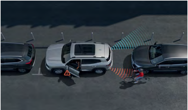
Предупреждение об открытой двери
